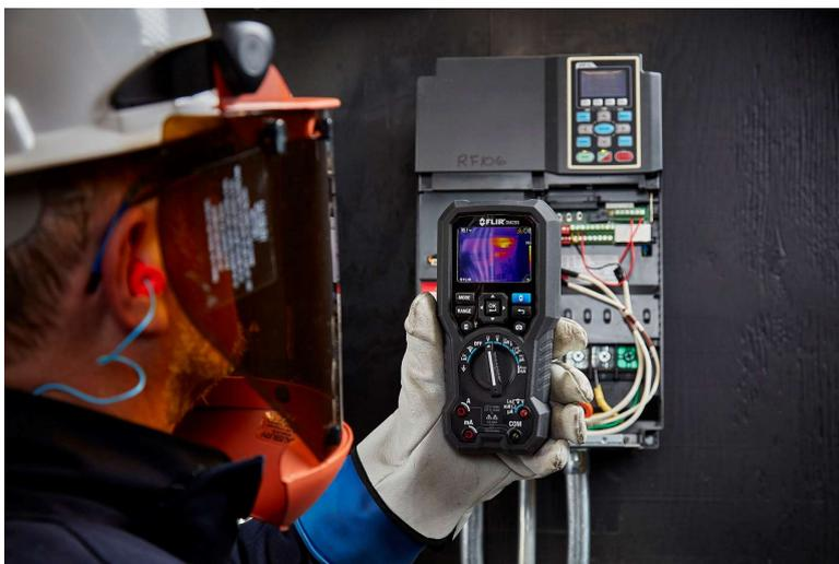
La **FLIR E53**, dotata della tecnologia MSX (Multi Spectral Dynamic Imaging), è la prima di una serie di termocamere portatili professionali che rendono la termografia accessibile a una vasta platea di tecnici della manutenzione che devono essere in grado di
