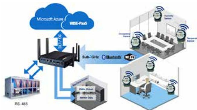
Con l'ultimo processore Intel Apollo E3900, l'UTX-3117 offre prestazioni eccellenti per la realizzazione di sistemi HVAC. Invia tutti i dati dell'edificio al cloud per l'analisi in modo che gli utenti ricevano informazioni in tempo reale tramite un pannello di controllo o un altro dispositivo portatile. Progettato con una soluzione termica ottimizzata per far sì che il sistema mantenga carichi di lavoro completi in ambienti critici fino a 60 ° C.
