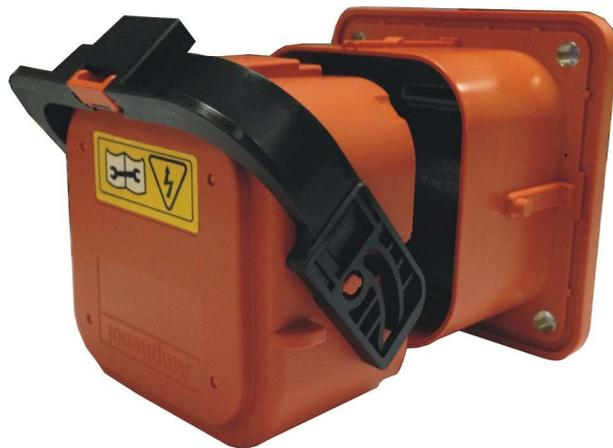
Il dispositivo MSD Amphenol è una soluzione sicura e affidabile per la manutenzione di veicoli PHEV. Dispone di una leva a due fasi per aprire il circuito HVIL (High-Voltage Interlock Loop) prima della separazione dei contatti ad alta tensione. Non necessita di utensili per scollegare la batteria ad alta tensione interna e, allo stesso tempo, protegge le batterie dai cortocircuiti. Tutte le superfici di conduzione ad alta tensione del gruppo di contenitori femmina sono 'touch-safe'.
