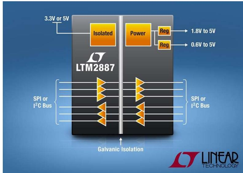
Nelle applicazioni dei sistemi industriali, i potenziali di massa possono variare notevolmente, spesso superando il range tollerabile, interrompendo le comunicazioni o addirittura distruggendo i componenti. L'LTM2887 interrompe i loop di terra isolando elettricamente l'interfaccia del
