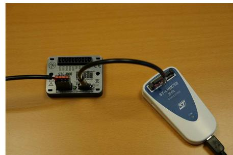
KEIL® µVision. Tutti i PLC sono dotati di 10 I/O e di un'interfaccia CAN per la comunicazione con dispositivi esterni.
