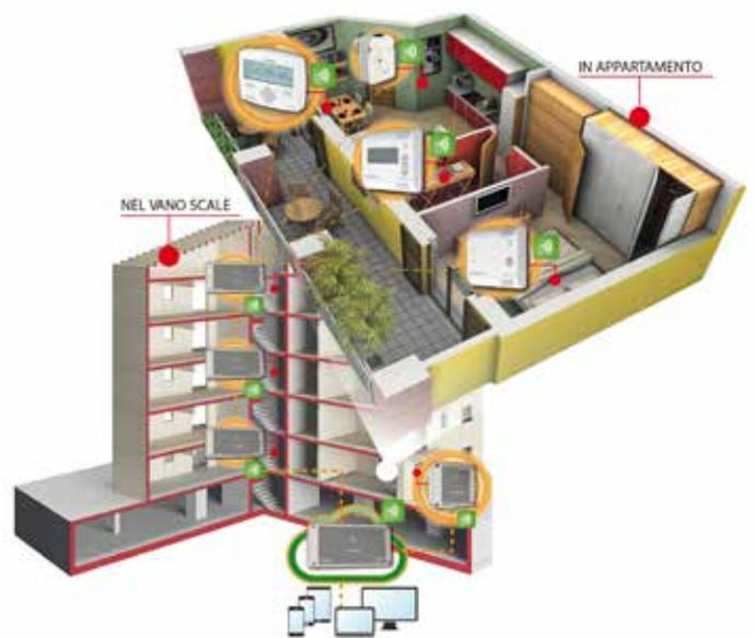
**FIGURA 2 - Esempio di schema di installazione condominiale: MaggiorDOMO raccoglie i dati dagli appartamenti tramite i ripetitori posti nel vano scale e li memorizza nel concentratore di impianto**
