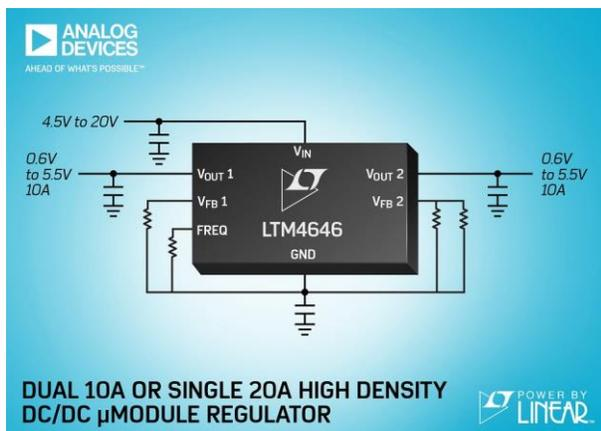
In confronto al modulo precedente con due uscite singole da 10A, l'LTM4646 riduce le dimensioni di progetto di oltre il 25%. Con la sua struttura a doppio regolatore, l'ingombro ridotto, la regolazione precisa della tensione, l'LTM4646 rispetta i limiti di spazio imposti dai PCB delle schede densamente popolate, per alimentare
