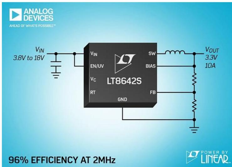
delle variazioni di layout del PCB, semplificando il progetto e riducendo i rischi anche con l'utilizzo di circuiti stampati a doppia faccia. Con una frequenza di switching di 2MHz sull'intero intervallo di carico, l'LT8642S supera agevolmente i requisiti dello standard automotive CISPR 25, Classe 5,
