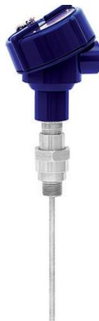
La **termoresistenza TR10** standard sopporta fino a 6 g di forza (da picco a picco) ed è anche disponibile in una versione opzionale resistente alle vibrazioni fino a 20 g. Per una versione altamente resistente alle vibrazioni, la cui punta del sensore è in grado di sopportare fino a 50 g, WIKA offre una speciale resistenza di misura a film sottile.
