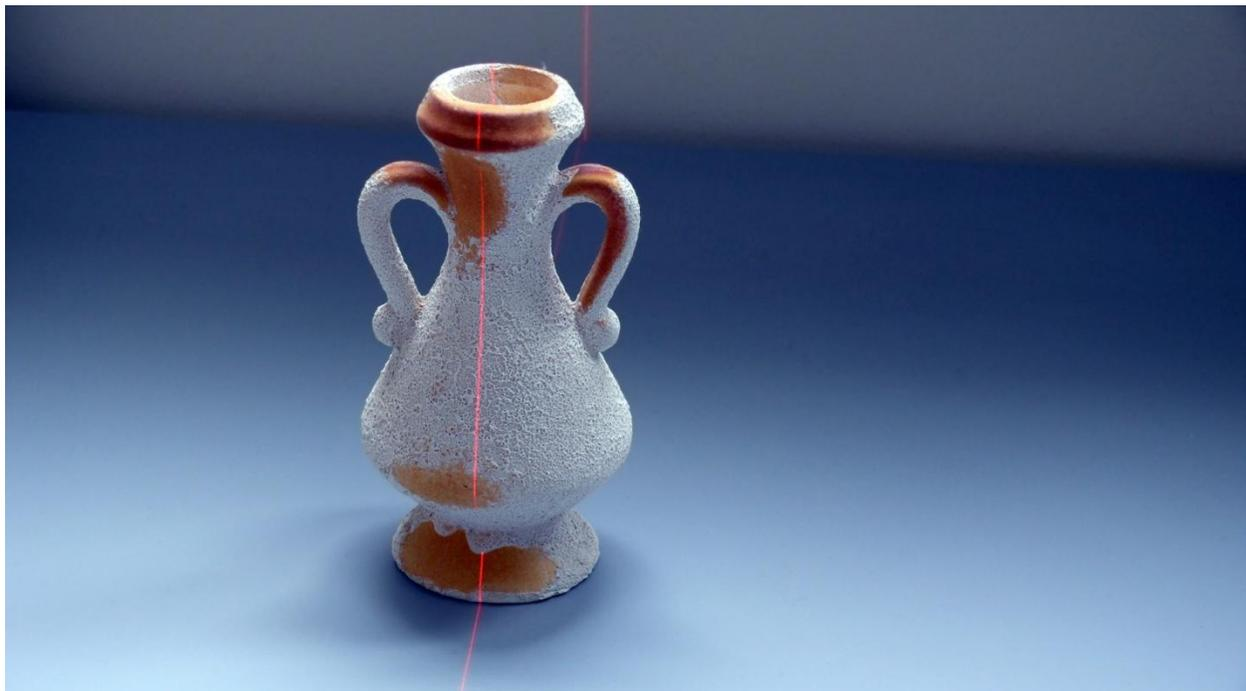
Figura 2.7. Oggetto di test per la ricostruzione 3D tramite stereoscopia e lama laser
