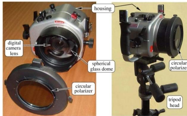
Figura 2.2. Sistema di videocamere aggiunto di filtri polarizzatori
