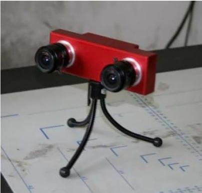
Figura 1.7. Dispositivo stereoscopico integrato
