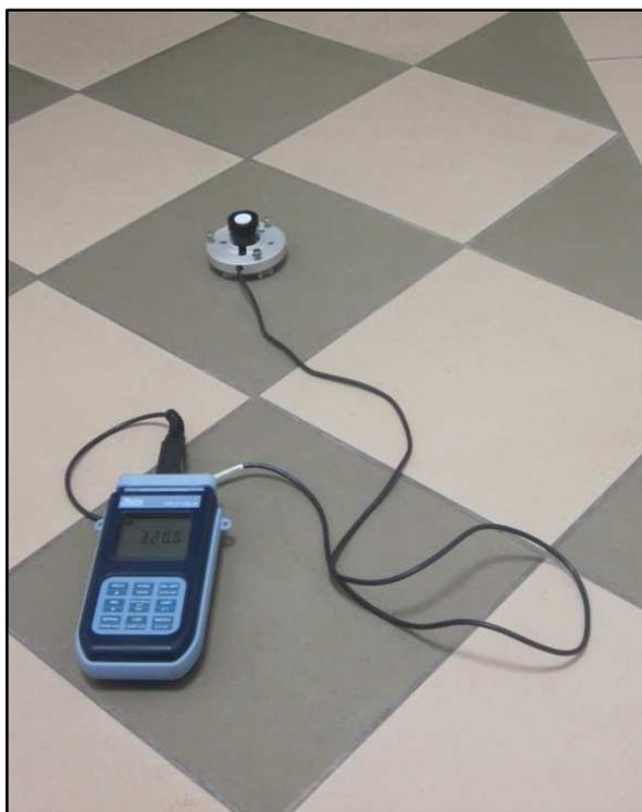
figura 5.7-Luxmetro e sonda per le misure di illuminamento orizzontale
