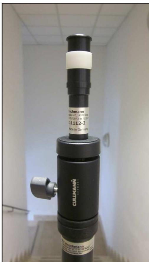
figura 5.9-Sonda per illuminamento semicilindrico
