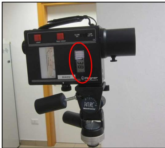
**Figura 5.34-** Luminanzometro con display di interfaccia
