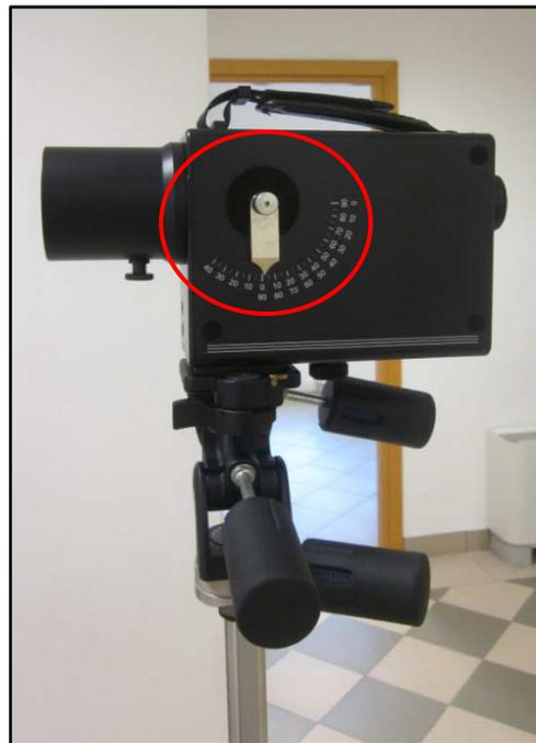
**Figura 5.35-** Luminanzometro con gradi di inclinazione apparecchio
