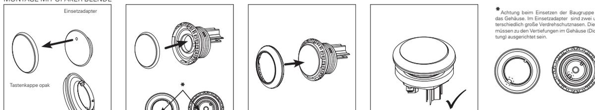
\* Achtung beim Einsetzen der Baugruppe in das Gehäuse. Im Einsetzadapter sind zwei unterschiedlich große Verdrehschutznasen. Diese müssen zu den Vertiefungen im Gehäuse (Dichtungen) ausgerichtet sein.
